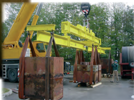
Essais en surcharge à 52 tonnes (150%). (CERN, Genève 2005)
